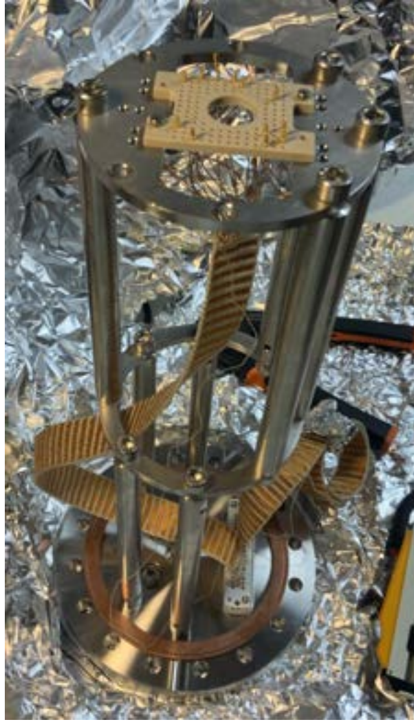
FIGURE 2.25 – Image du support du piège en cours de connection des nappes au support du CPGA. Les câbles coaxiaux ne sont pas encore montés.
