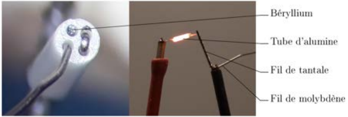
FIGURE 2.6 – À gauche : photo du four à béryllium, on peut y voir le tube blanc en alumine dont un des trous contient le béryllium. À droite : photo du four soumis à 2.5A dans l'air, on peut voir le tube en alumine qui rougeoit et le fil de tantale s'enrouler de part et d'autre sur des fils de molybdène. Ces images sont tiré de la thèse de Thomas Louvradoux [58]
